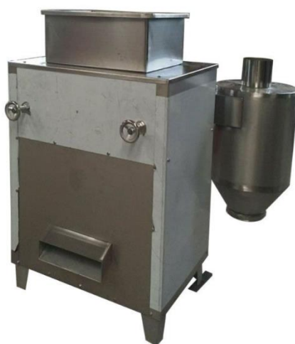
Obr. 1.2 Lúpací stroj na kakaové bôby
